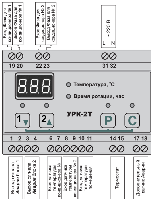
Рис.2 Схема подключения.
